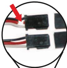
Bei Verwendung von 2 Reglern darf nur 1 BEC verwendet werden, da ansonsten beide Regler zerstört werden.
