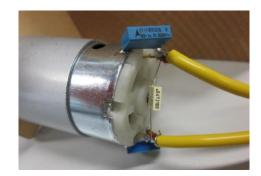
Bei der Anbringung der beiden 1 nF Kondensatoren (C1) ist eine sehr kurze Drahtlänge wichtig. Die Leitungslängen zwischen Regler und Motor dürfen nicht länger sein als 20cm. Außerdem muss der beiliegende Ferrit über beide Leitungen Motor-Regler ca. mittig gezogen werden (Ferritkern vor löten der Kabel einfädeln).
