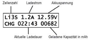
Wenn der Ladevorgang abgeschlossen ist, wird ein Tonsignal ausgegeben (sofern nicht ausgeschaltet). Falls Sie den Ladevorgang vorher beenden wollen, drücken Sie die Taste *Batt Type/Stop*.
