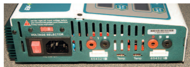
Beim Torcster 4B6 Quattro sitzen auf der linken Seite der Netzanschluss, darüber der rote Umschalter zwischen 110 und 220 Volt und zwei Anschlüsse zum Akkuladen. Positiv hervorzuheben ist, dass der Lader einen »echten« Ein-/Ausschalter hat.
