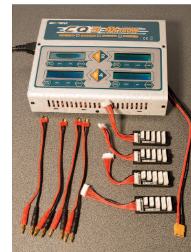
Der Lieferumfang des Torcster 4B6 Quattro kann mit je vier Ladekabeln und Balancerboards und einem Anschlusskabel glänzen.
